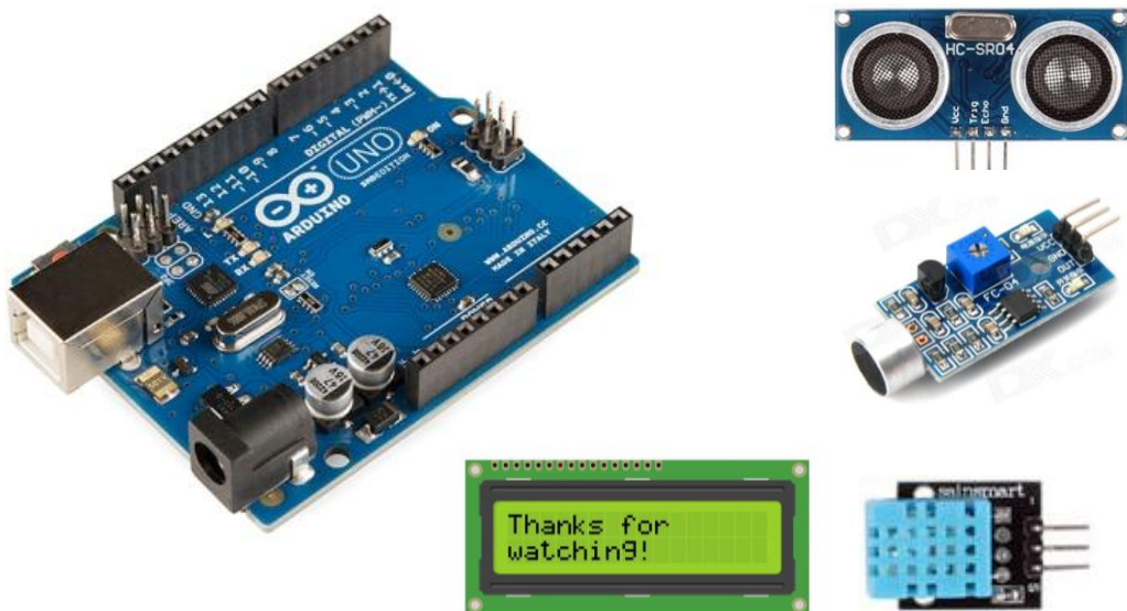
Σχήμα 4.7: Arduino Uno και περιφερειακά για την ανάπτυξη εφαρμογών.
